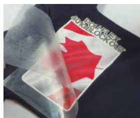
7：プレス後、熱いうちに表面の「854」を剥がす。
