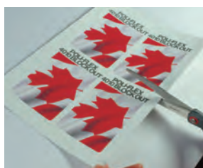
1：プリント後、乾燥させた画像を適当な大きさにカット。
