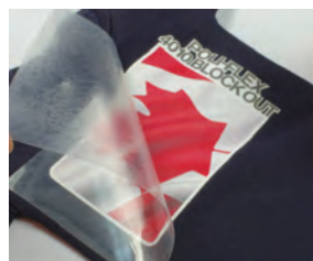
7 : プレス後、熱いうちに表面の「854」を剥がす。
