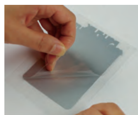
4：裏にして、ペットフィルムを静かに剥がす。
